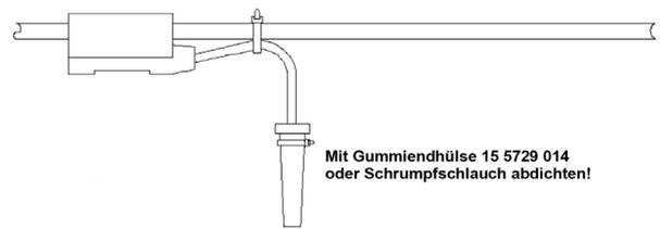
Das „alte Kabel“ wird am Ende mittels Gummiendhülse (Art.Nr. 15 5983 024) wasserdicht eingeschrumpft.
